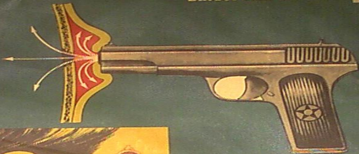
МЕХАНИЗМ ОБРАЗОВАНИЯ ШТАНЦМАРКИ
