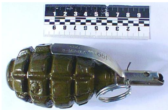
Рис. 1 Граната Ф-1 із запалом УЗРГМ
