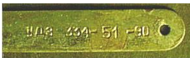
Рис.35 Маркування важеля запалу УДЗ
